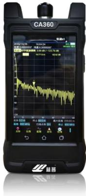
**CA360手持式天馈线分析仪**是一款采用Android操作系统的精密测量仪表，支持测试频率范围广，（300kHz-6000MHz），配备高分辨率彩色触摸屏，体积小，重量轻，易于携带，可用于天馈系统的匹配性测试。通过精准测量回波损耗、电压驻波比、线缆损耗等参数来准确地评估系统性能，并可选配通过式功率传感器进行射频功率测量。
