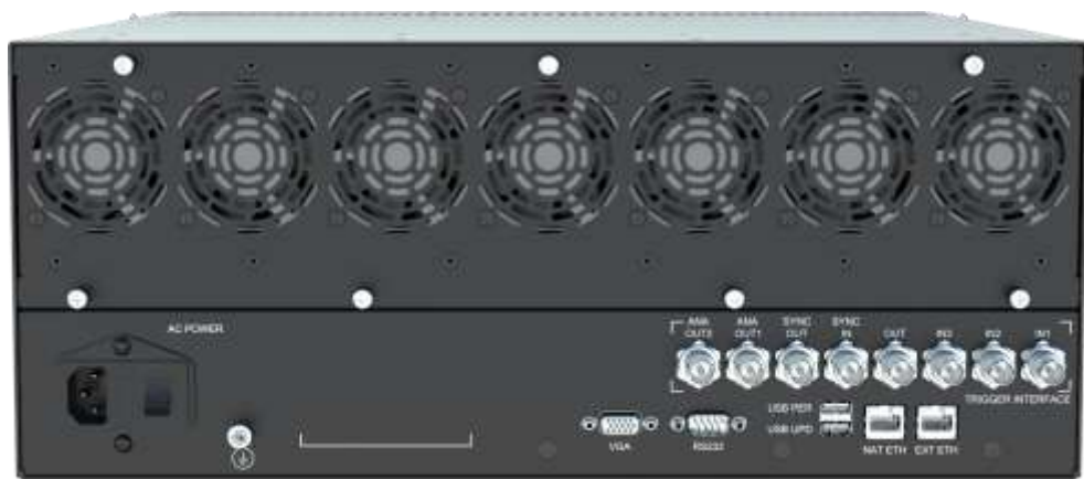
F1200/F1200T 机箱结构和接口（后）
