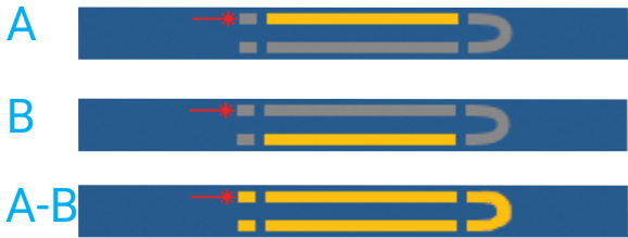
使用iOLM（光眼）上的环回测试方法和iLOOP选件，可同时测试两条光纤。只查看链路A、链路B或包括环路的整个A-B链路。
