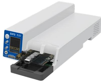
MCB板卡易于替换，与误码仪直接接触
