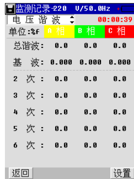
图 5-3 监测记录电压谐波
