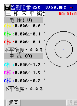
图 5-6 监测记录电压/电流不平衡
