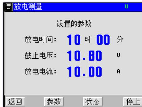
此时显示有电池电压、放电电流、已放容量、已放电时间/设置放电时间值。按【参数】键，显示设置的参数信息。
