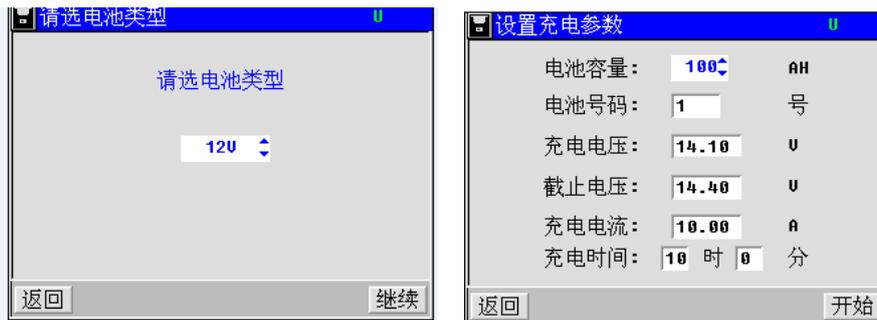
选择好电池类型后，按【继续】键进入电池充电设置界面，此时需设置电池容量、电池号码、截止电压、充电电流、充电时间六个参数。通过上下左右方向键在各参数栏之间进行切换，上下键设置数值。按【返回】键返回主菜单。其中：
