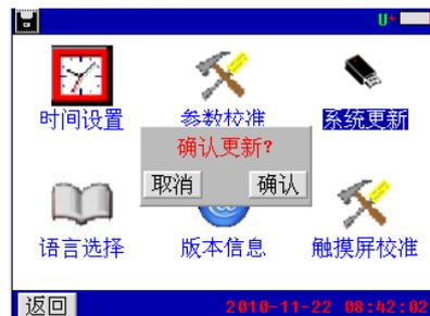
点击【确认】按钮，即进入软件更新程序。此时仪表自动重启，并载入 U 盘的更新文件至仪表，软件更新完成后，仪表进入开机界面，可进行正常的操作。点击【取消】按钮取消更新程序。
