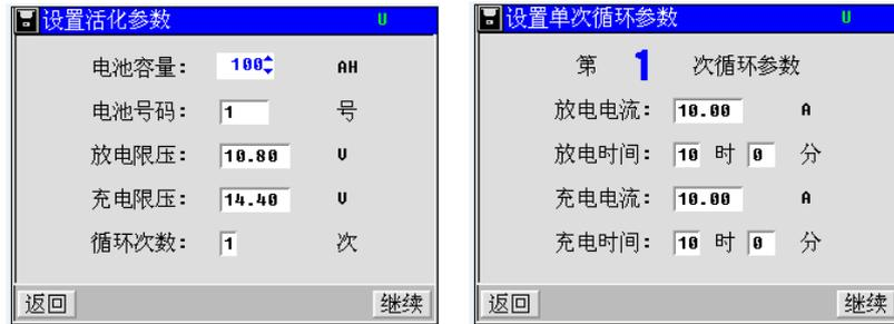
当选择完“循环次数”之后，可以按确定进入循环设置，设置参数有放电电流、放电时间、充电电流、充电时间。或者按【返回】键，返回主菜单。其中放电及充电参数设置参考<电池充电>及<电池放电>。
