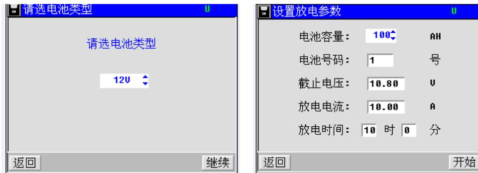
选择好电池类型后，按【继续】键进入电池放电设置界面，此时需设置电池容量、电池号码、截止电压、放电电流、放电时间五个参数。通过上下左右方向键在各参数栏之间进行切换，上下键设置数值。设置好放电参数按【开始】键，进入放电状态指示界面。按【返回】键返回主菜单。其中：
