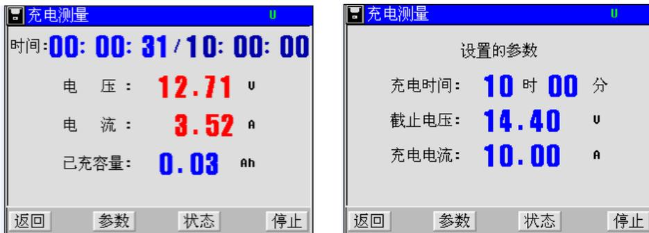
此时显示有电池电压、充电电流、已充容量、已充电时间/设置时间值。按【参数】键，显示设置的参数信息。
