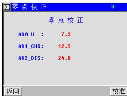
点击“校准”按钮，界面显示“正在校准...”即进入零点校准环节，校准完成后显示“校准完成!”。
