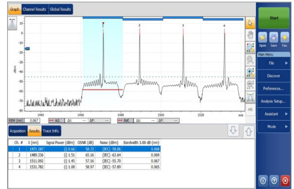
FTBx-5235显示通道功率、通道波长和OSNR。上：OSA在测试CWDM网络时的显示结果。下：OSA在测试DWDM网络时的显示结果。
