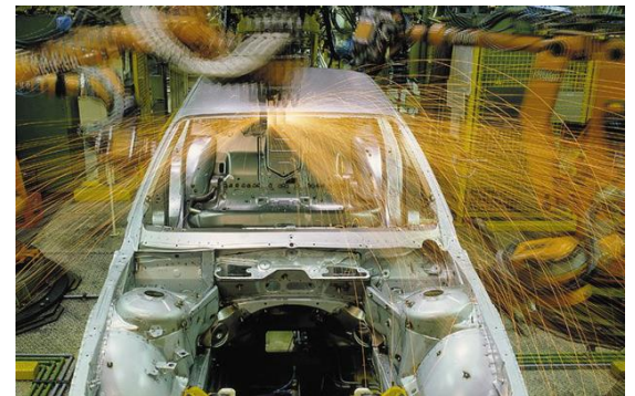
电阻焊接机生产中
