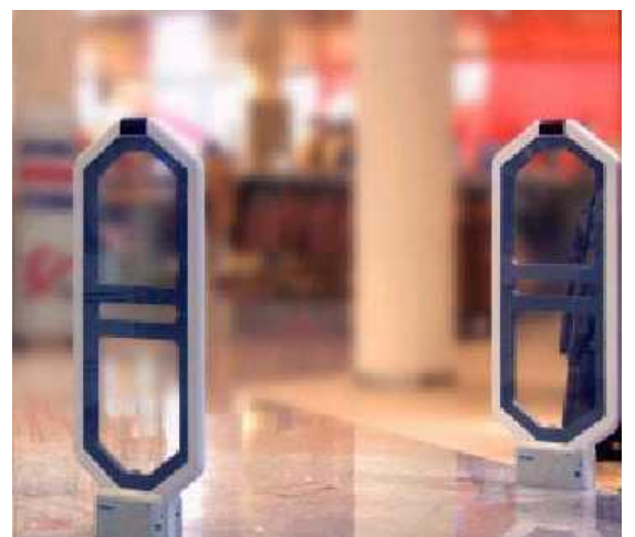
货品监管中使用的磁感应门
