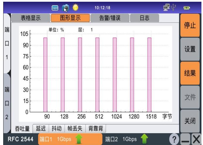
RFC2544支持**远端环回模式**，此模式下测试结果从测试主设备到环回点再返回到测试主设备，测试结果是来回方向的平均值。
