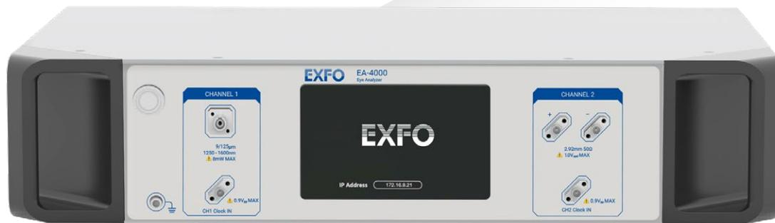
速度在业内出类拔萃的采样示波器，支持28G NRZ信号眼图分析。
