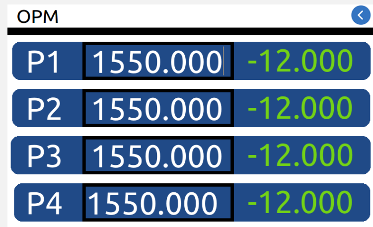
OPM界面(波长配置、光功率显示)
