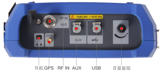
耳机GPS RF IN AUX USB 音量旋钮
