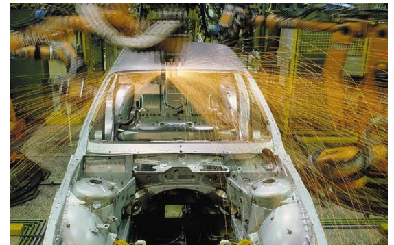
电阻焊接机生产中
